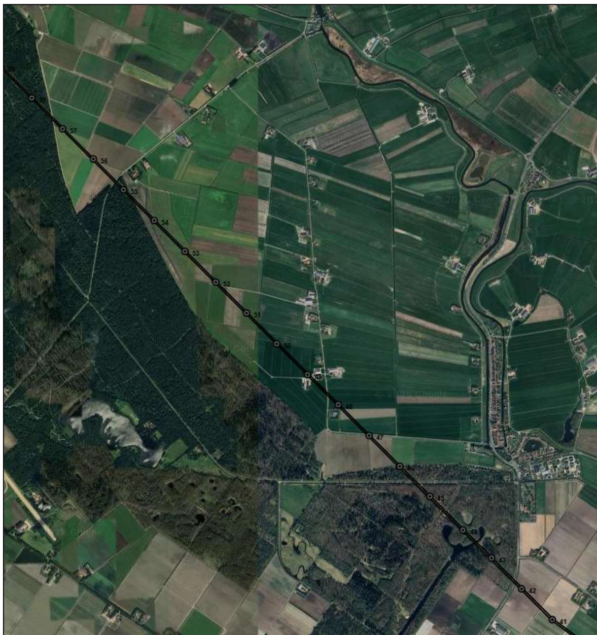
Figuur D-5 Luchtfoto waarin de bestaande 110 kV-verbinding binnen ons grondgebied (westelijk van Kuinre) met een zwarte lijn (en de bijbehorende mastnummers 47 t/m 54) is aangeduid. 75
