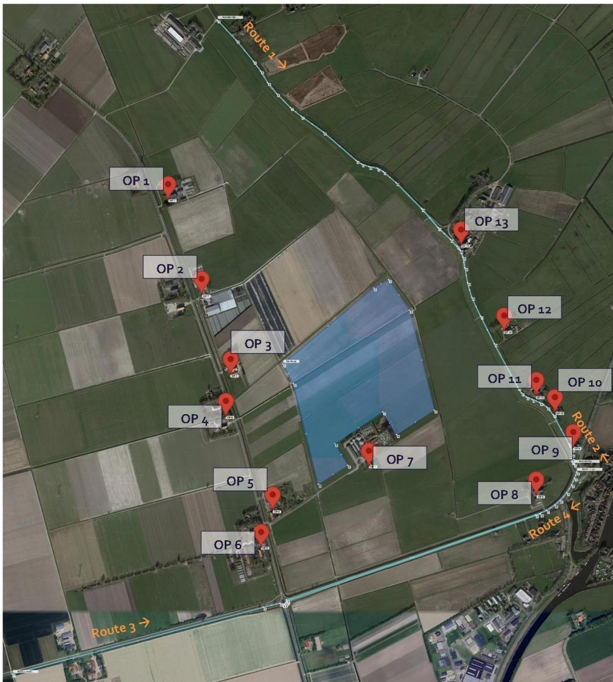
Figuur 4.1: Ingetekende zonnepark (transparant blauwe vlak) met daarbij de vier routes waarvoor de reflectie berekend wordt en de observatiepunten.
