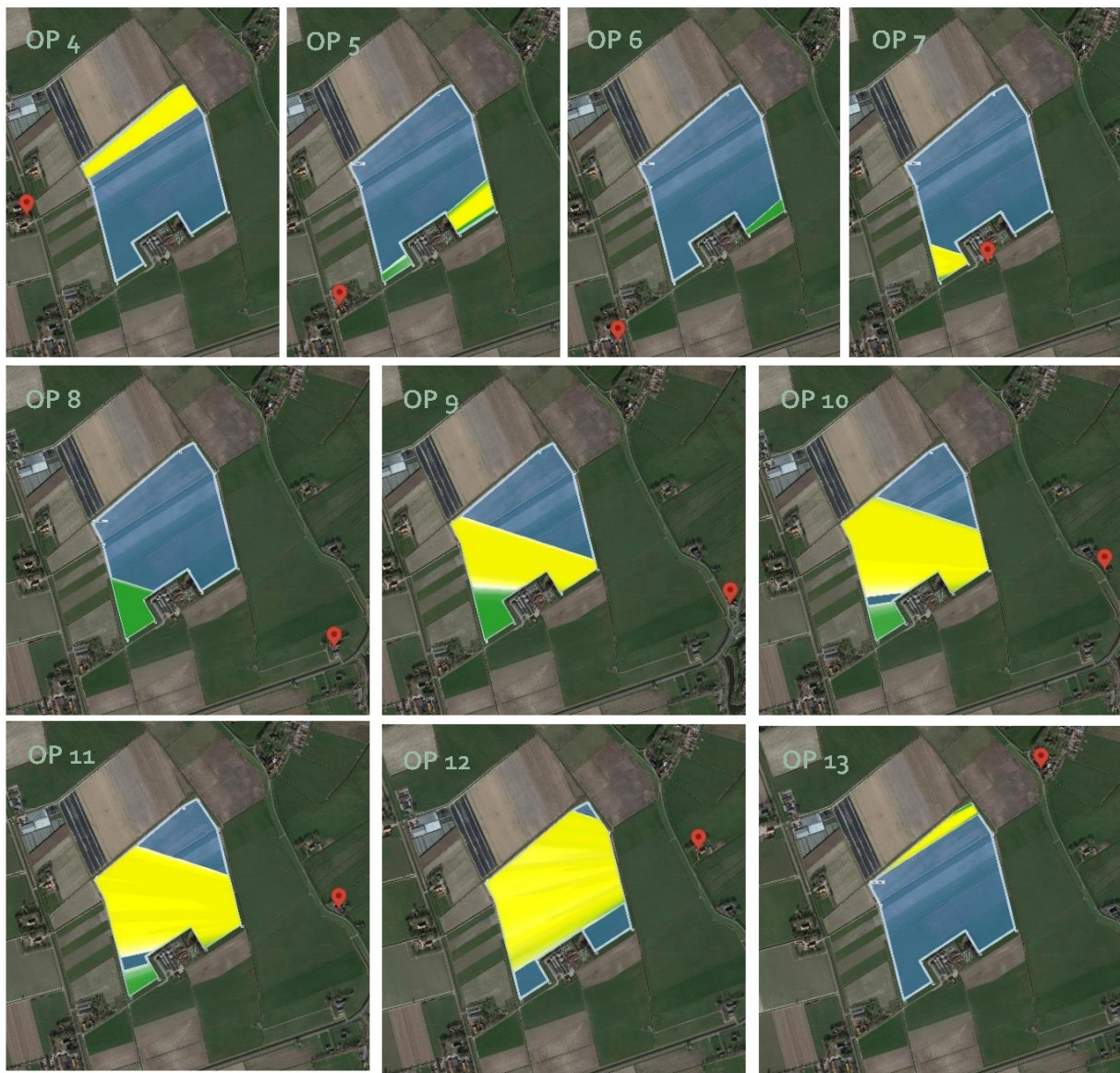
Figuur 4.8: Schitterende delen van de zonnepanelen, zichtbaar vanaf de observatiepunten waar reflectie kan worden waargenomen bij textured glass op de eerste verdieping. Hoe geler de kleur, hoe meer reflectie.
