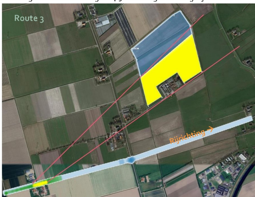
Figuur 4.5: Schitterende delen van de zonnepanelen, zichtbaar vanaf route 3 en de plekken op de route waar de reflectie tot hinder leidt bij textured glass . Hoe geleer de kleur, hoe meer reflectie. In rood hulp zichtlijnen van de route naar de bron.
