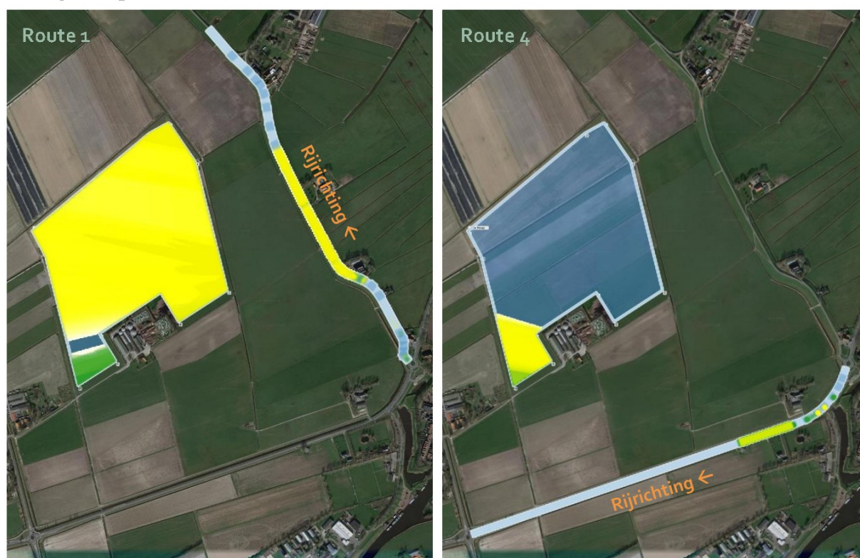
Figuur 4.2: Schitterende delen van de zonnepanelen, zichtbaar vanaf route 1 (links) en route 4 (rechts) en de plekken op de route waar de reflectie tot hinder leidt bij smooth glass . Hoe geler de kleur, hoe meer reflectie.
