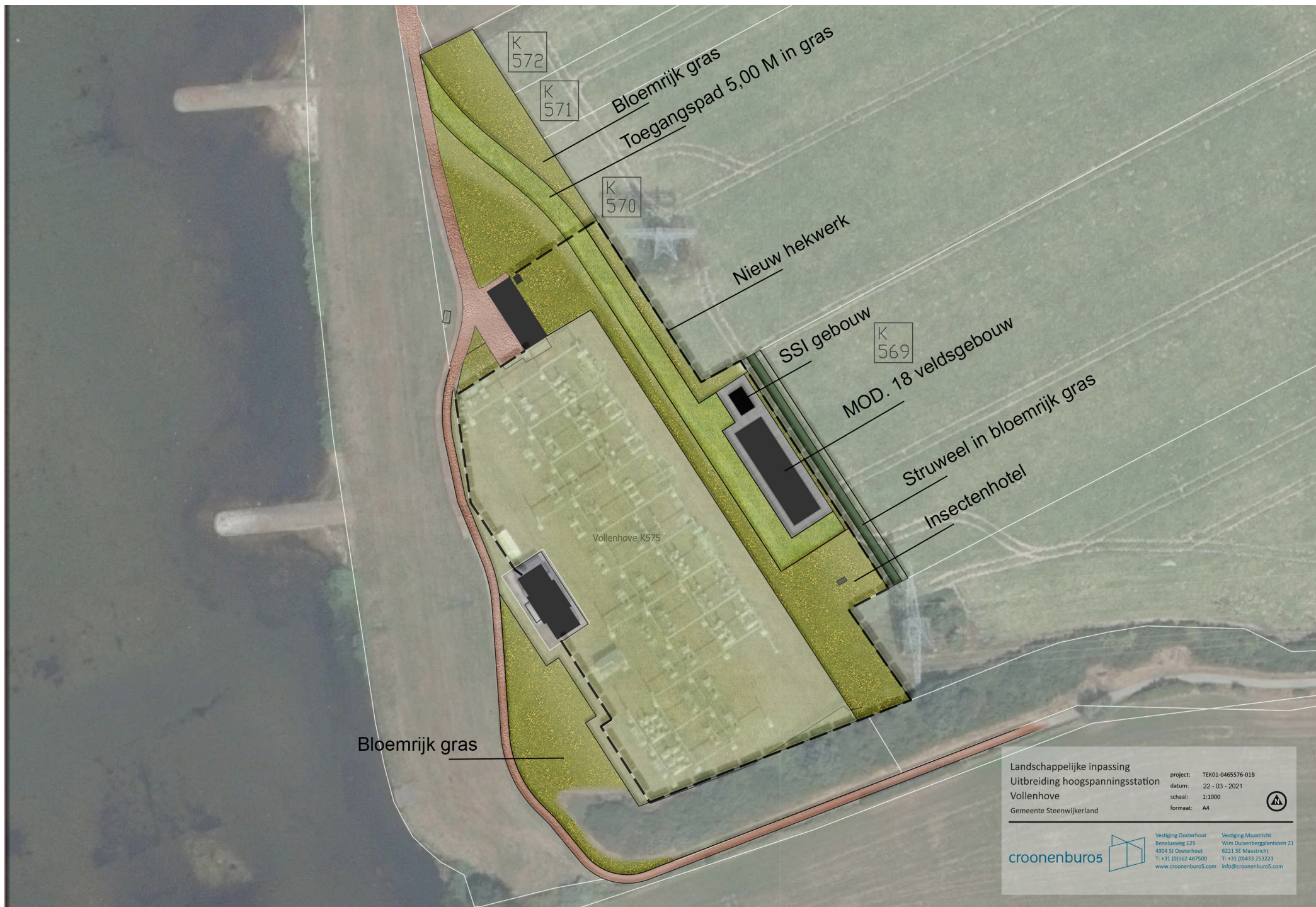
Figuur 23: Uitwerking landschappelijke inpassing uitbreiding hoogspanningsstation Vollenhove
