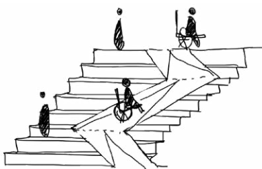
Hellingbaan of lift om hoogte te overbruggen
