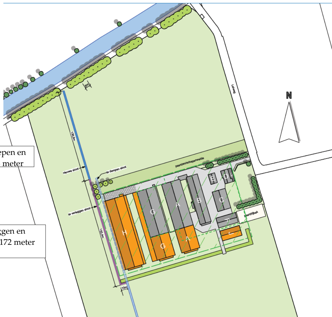
Figuur 4-15 Uitsnede situatieschets bijlage 2 met daarop waterbergende voorziening
